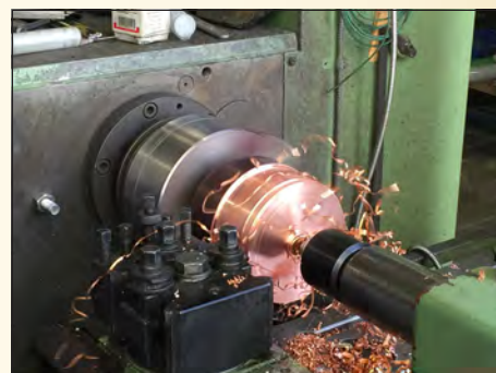
De koperen bodemplaat wordt gedraaid
